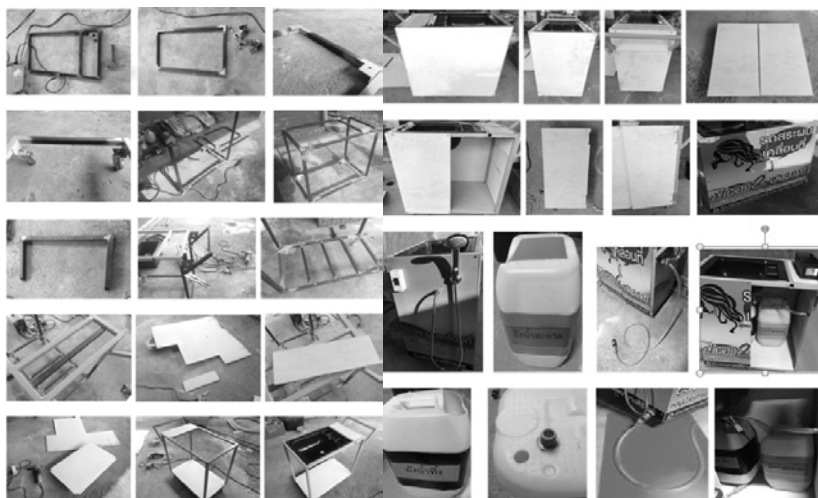
ภาพที่ 2 ขั้นตอนการประดิษฐ์นวัตกรรมรถสละผสมเคลื่อนที่ ปาวา 2 ซาลอน
