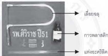
ภาพที่ 1 อุปกรณ์ที่ใช้ประดิษฐ์ Trauma Thrombin Glue Triple Mixture Syringe
