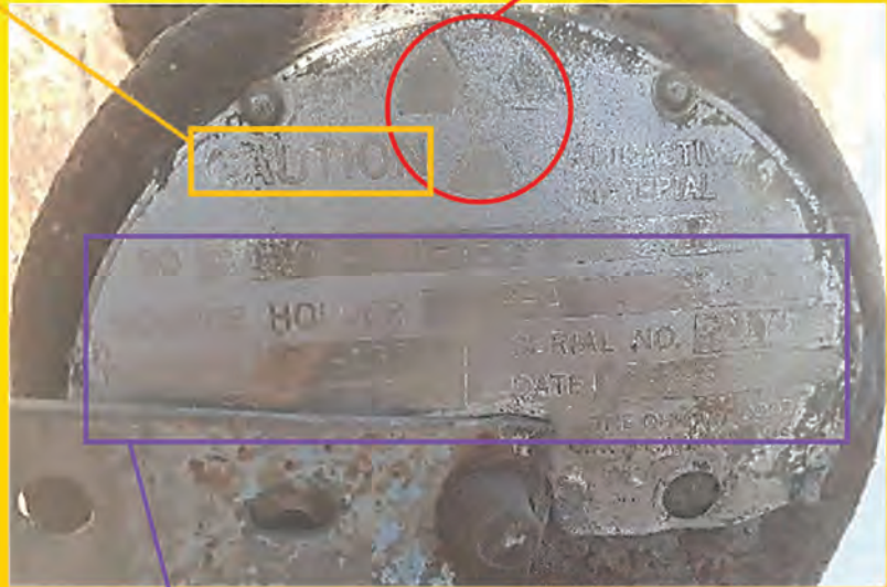
ข้อความแสดงข้อมูลชนิดของวัสดุกัมมันตรังสี ความแรง/ปริมาณของวัสดุกัมมันตรังสี ปีที่ทำการผลิต/ทำการปรับเทียบความแรงของวัสดุกัมมันตรังสี
